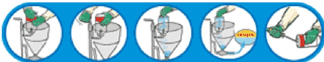
1. Após o esvaziamento, encaixar a embalagem no local apropriado do funil instalado no pulverizador;
